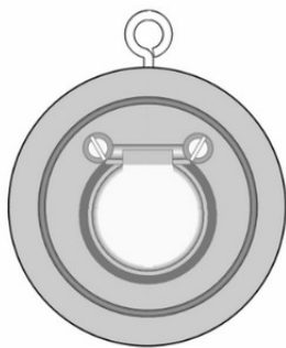
Межфланцевый обратный CROV ПВХ, EPDM, FIP d160 (DN150)
