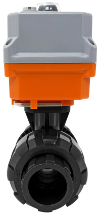
Шаровой кран IVKD ПВХ с эл.приводом 220V AC, муфтовые окончания, FKM, IPS d50 (DN40)
