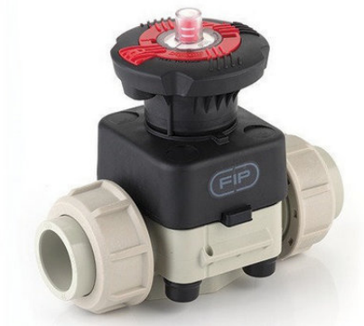
Мембранный клапан DKUIM с муфтовыми окончаниями (уплотнение EPDM / мембрана EPDM) PP-H d63 (DN50)
