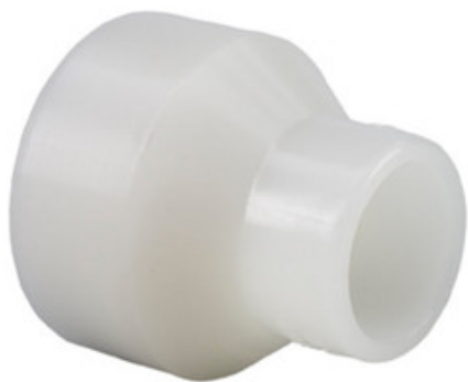
Редукционная муфта ПВДФ 25х20 SDR21 PN16
