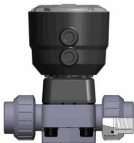
Мембранный клапан ДК ПБХ с пневмоприводом НЗ, PN6, резьбовые окончания, EPDM, FIP R1" (DN25)
