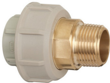
Муфта разборная переходная PP-H / латунь, НР (EPDM) FIP 32x1 PN10
