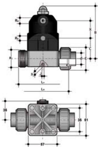
Компактный мембранный клапан СМ ХПВХ с пневмоприводом НЗ с муфтовыми окончаниями d20 (DN15)
