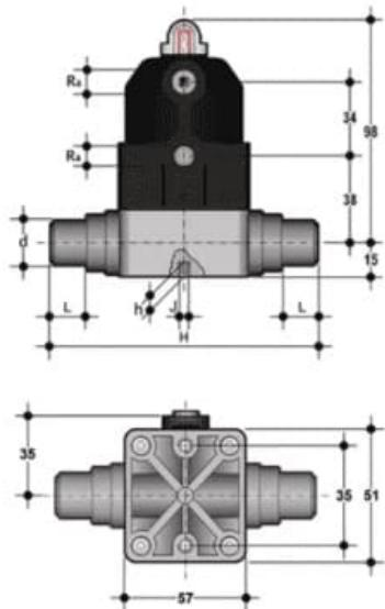
Компактный мембранный клапан СМ с пневмоприводом ДвД с резьбовыми окончаниями
