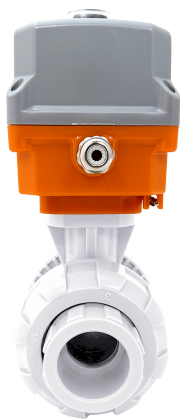
Шаровой кран IVKD ПВДФ с эл.приводом 220V AC, муфтовые окончания, EPDM, IPS d63 (DN50)
