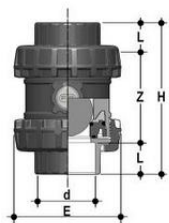
Шаровой обратный клапан SXE ХПВХ с муфтовыми окончаниями, DN65-100 d75 (DN65)
