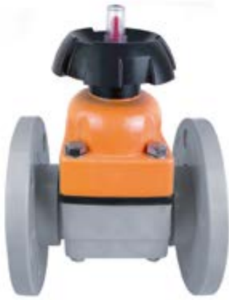
Мембранный клапан с фланцевыми окончаниями ХПВХ IPS d75 (DN65)
