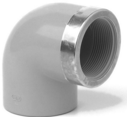
Отвод переходной ВР с усиливающим кольцом ХПВХ 40x1 1/4" PN16
