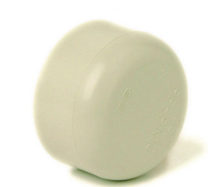
Заглушка для раструбной сварки PP-H FIP d63 PN10
