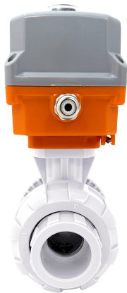
Шаровой кран IVKD ПВДФ с эл.приводом 24V DC, муфтовые окончания, FKM, IPS d50 (DN40)
