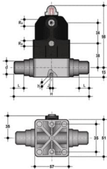
Компактный мембранный клапан СМ с пневмоприводом ДвД с муфтовыми окончаниями (уплотнение EPDM/мембрана EPDM) PP-H d20 (DN15)
