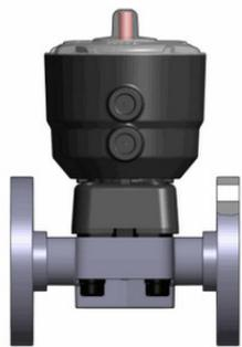
Мембранный клапан ДК ХПВХ с пневмоприводом НЗ, РН10 с фланцевыми окончаниями d63 (DN50)
