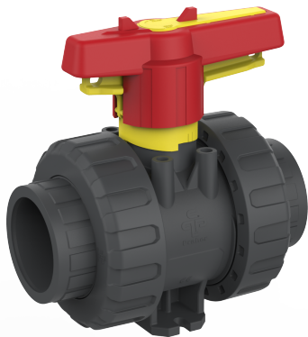
Шаровой кран ПВХ промышленного применения с муфтовыми окончаниями, EPDM, Praher Plastics d32 (DN25)
