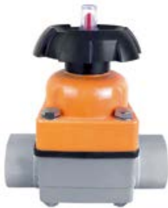
Мембранный клапан с втулочными окончаниями ХПВХ IPS d20 (DN15)
