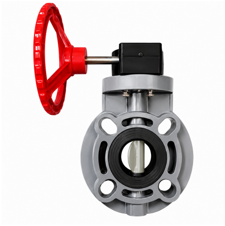
Затвор дисковый в корпусе FRPP (диск — ПП-гомополимер) с редуктором промышленного применения FKM IPS d90 (DN80)
