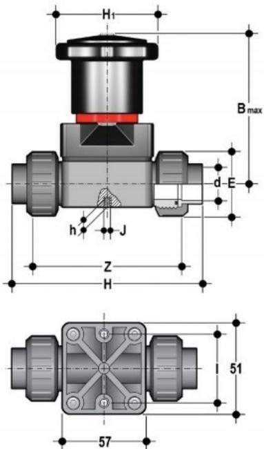
Компактный мембранный клапан SMUIV ПВХ с разборными муфтовыми окончаниями, EPDM, FIP d20 (DN15)
