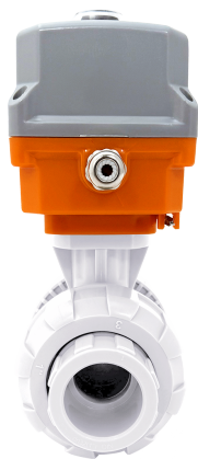
Шаровой кран IVKD ПВДФ с эл.приводом 24V DC, муфтовые окончания, FKM, IPS d63 (DN50)
