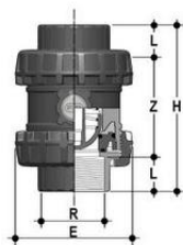
Пружинный шаровой обратный клапан SSE ПБХ; с резьбовыми окончаниями; DN65-100, FKM, FIP R4" (DN100)
