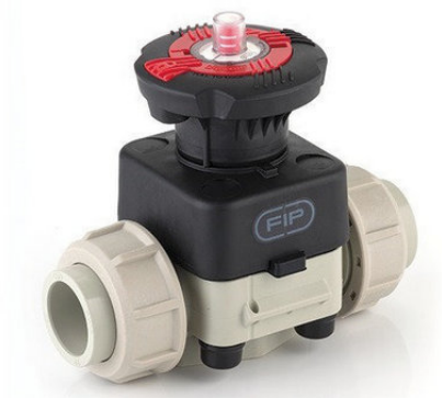
Мембранный клапан DKUIM с муфтовыми окончаниями (уплотнение FKM / мембрана FKM) PP-H d32 (DN25)
