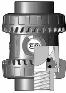
Шаровой обратный клапан SXEFV ПВХ; с резьбовыми окончаниям, EPDM, FIP R1" (DN25)
