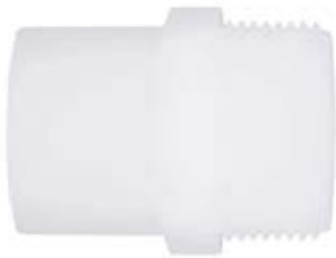
Редукционная муфта ПВДФ с НР для раструбной сварки 63х2" PN 16
