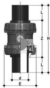
Шаровой обратный клапан SSEBEV ПВХ; с ПЭ патрубками; DN65-100, FKM, FIP d110 (DN100)
