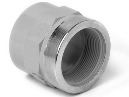
Переходная муфта с усиливающим кольцом ХПВХ 25x3/4" PN16
