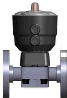
Мембранный клапан DK с пневмоприводом НЗ, PN10 с фланцевыми окончаниями (уплотнение FKM/мембрана PTFE) PP-H d25 (DN20)
