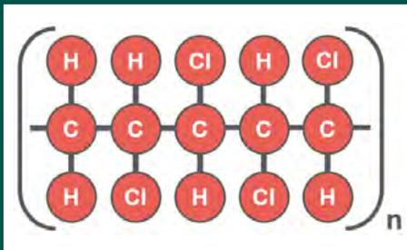
Хлорированный поливинилхлорид (ХПВХ или CPVC) — термопласт, получаемый путём хлорирования поливинилхлорида (ПВХ) с целью увеличения его термостойкости.
