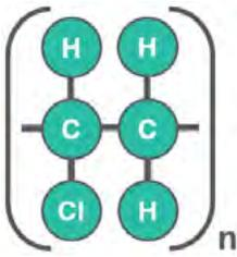
Поливинилхлорид (ПВХ или PVC) — бесцветная, прозрачная пластмасса, термопластичный полимер винилхлорида. Отличается химической стойкостью к щелочам, минеральным маслам, многим кислотам и растворителям.
